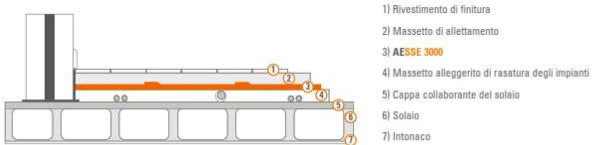
Dopo l'installazione degli impianti e il livellamento con il massetto alleggerito, prima del massetto di allettamento.
