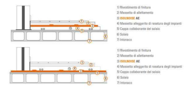
Dopo l'installazione degli impianti e il livellamento con il massetto alleggerito, prima del massetto di allettamento, oppure direttamente sulla cappa collaborante del solaio prima del massetto alleggerito.
